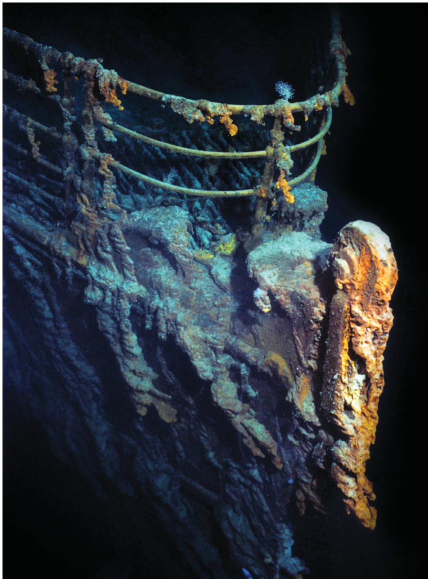
Рис. 9. Покрытая наростами ржавчины носовая оконечность «Титаника», заснятая с ГОА «Мир-1» в конце 1990-х или начале 2000-х гг. Из архива NOAA/РАН
