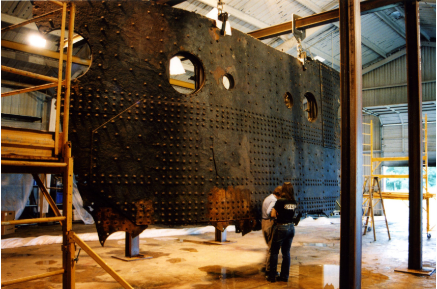
Рис. 8. The Big Piece (фрагмент наружной обшивки (ширстрека) правого борта размером приблизительно 8x4 м и массой более 15 т) во время реставрации в 2004 г.
