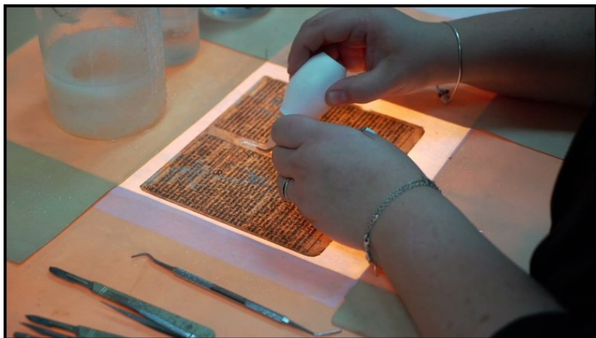
Рис. 1.4. Листы книги «Библия Лютера. Новый Завет: Второе послание к коринфянам святого апостола Павла», XVII век. Восполнение утрат методом долива бумажной массой на вакуумном столе
