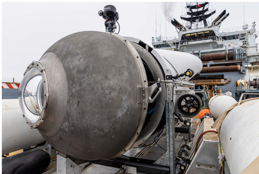
Рис. 1. Открытая носовая полусферическая титановая крышка («купол») мини-субмарины с центральным смотровым иллюминатором из плексигласа диаметром 53 см (по заявлению компании-владельца, крупнейшим из иллюминаторов на всех глубоководных аппаратах). По некоторым сведениям, стекло в иллюминаторе было сертифицировано только для глубины 1300 м. «Купол» использовался как посадочная дверь и при заdraивании герметизировался снаружи с помощью 18 (17) заporных болтов. Фотография Дэвида Конкэннона
