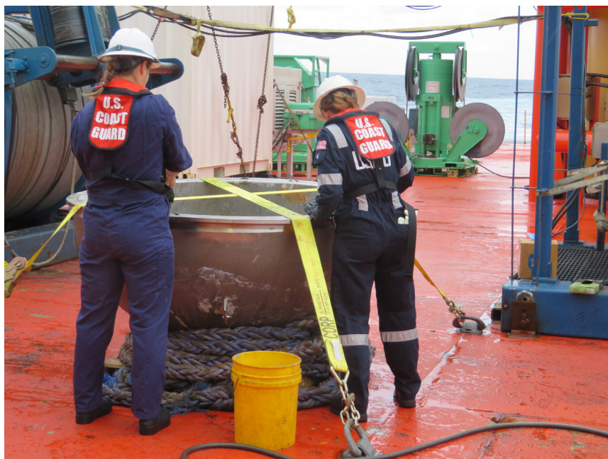
Рис. 11. Специалисты по безопасности мореплавания Береговой охраны США, входящие в состав Морского совета по расследованию дела о крушении ГОА «Титан», проводят обследование поднятой со дна фронтальной титановой крышки аппарата 1 октября 2023 г. Фрагмент был отправлен на станцию Береговой охраны в Ньюпорте, Род-Айленд, для дальнейшего анализа. Из открытых источников (Melissa Leake/National Transportation Safety Board)
