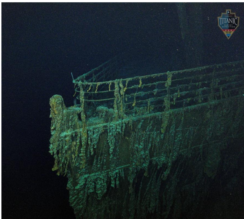
Рис. 6. Носовая оконечность «Титаника», покрытая наростами так называемой сосульчатой ржавчины. Часть леера левого борта к настоящему времени обрушилась, вину за это повреждение некоторые возлагают на «Титан». На заднем плане вверху справа – якорный кран-балка. Июль 2021 г. Из архива OceanGate Expeditions
