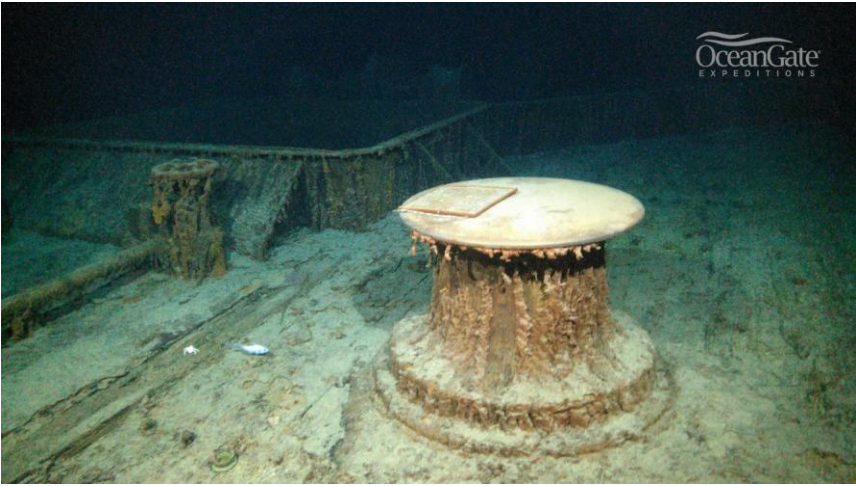
Рис. 8. Левый борт палубы бака «Титаника» в районе люка грузовой шахты № 1. На переднем плане – якорно-швартовный шпиль с паровым приводом, на его литой бронзовой крышке лежит мемориальная табличка. Слева – рыба-гренадер и рак мунидопсис. Июль 2022 г. Из архива OceanGate Expeditions
