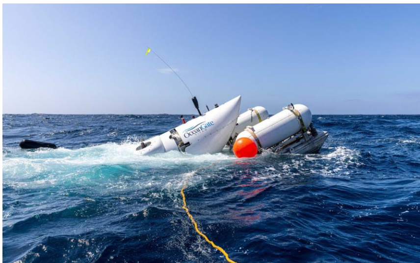
Рис. 4а, б. ГОА «Титан» на полупогружной платформе, спущенной с кормы судна-носителя Horizon Arctic (а), и непосредственно при уходе под воду (б).
