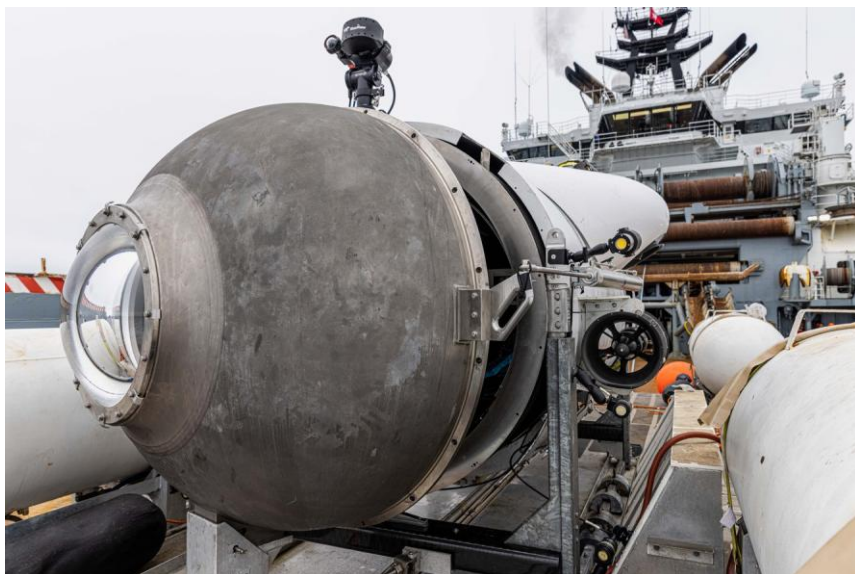
Рис. 1. Открытая носовая полусферическая титановая крышка («купол») мини-субмарины с центральным смотровым иллюминатором из плексигласа диаметром 53 см (по заявлению компании-владельца, крупнейшим из иллюминаторов на всех глубоководных аппаратах). По некоторым сведениям, стекло в иллюминаторе было сертифицировано только для глубины 1300 м. «Купол» использовался как посадочная дверь и при задранивании герметизировался снаружи с помощью 18 (17) запорных болтов. Фотография Дэвида Конкэннона
