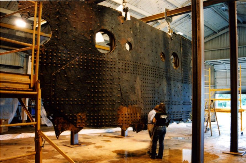
Рис. 8. The Big Piece (фрагмент наружной обшивки (ширстрека) правого борта размером приблизительно 8х4 м и массой более 15 т) во время реставрации в 2004 г.
